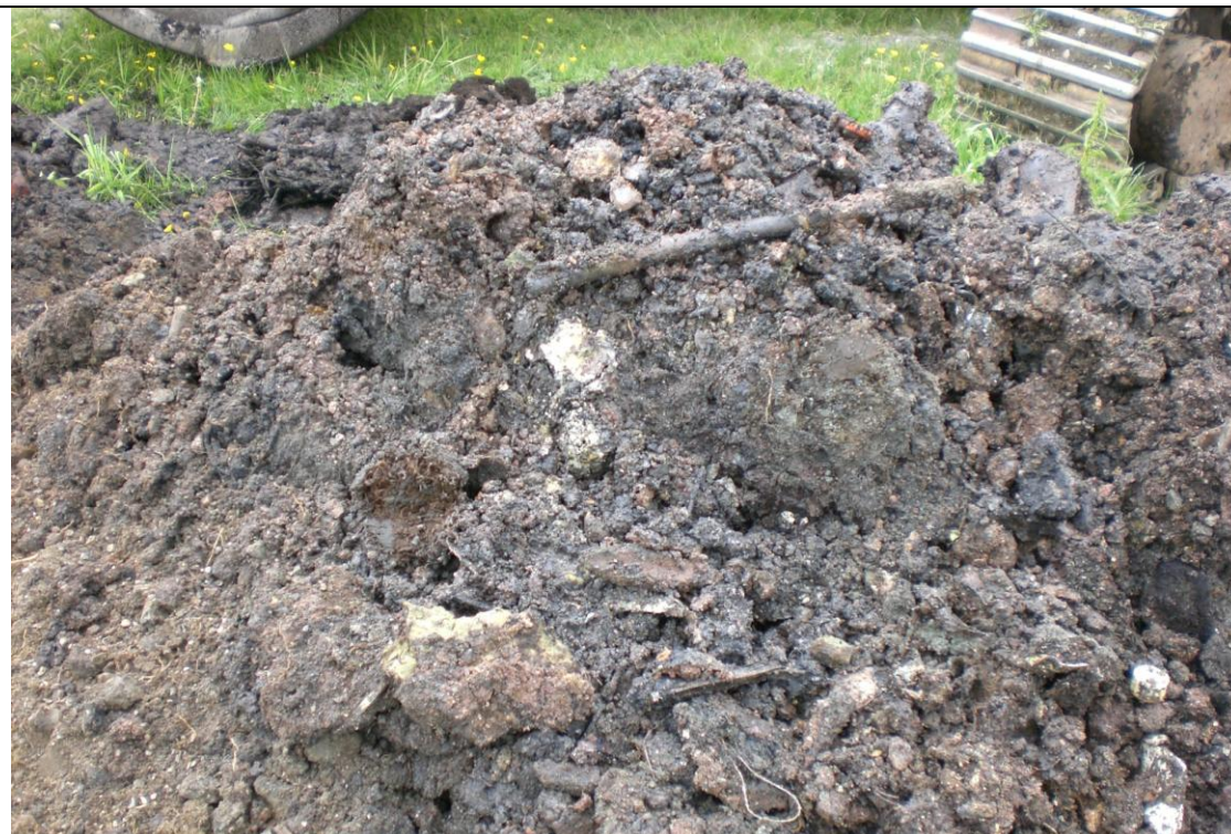
Foto 4-2. Sjakt 4. Oppgravde avfallsmasser har en viss struktur. Det meste av avfallet er en diffus "matrix", men det er innslag av flasker, lær (sko), tre mm.. Svært lite stein.
