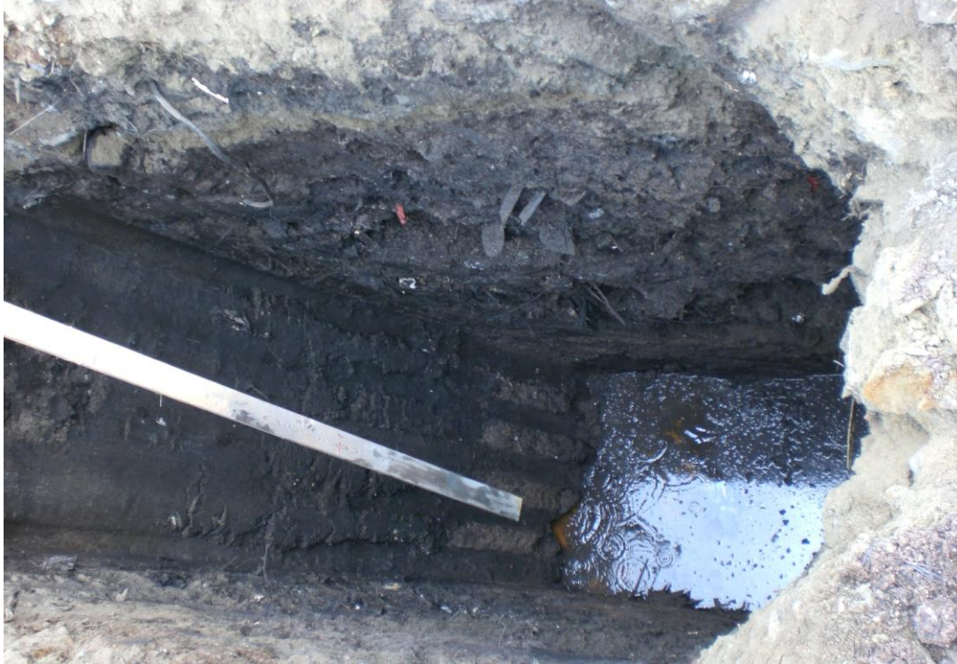
Foto 6-1. Sjakt 6. Relativt tørt avfall. Jernbrunt vann pipler inn fra ca 5 meter under terreng, der det er fjell. Sjaktveggene er stabile, og massene er gravbare.
