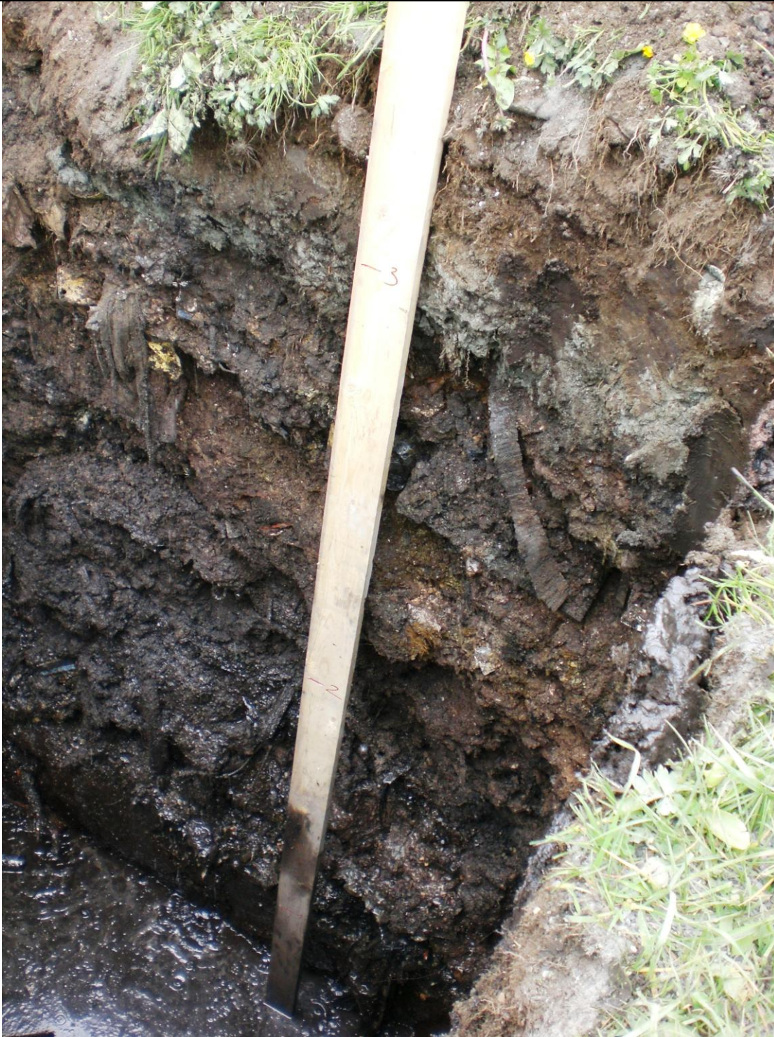
Foto 4-1. Sjakt 4. Relativt tørt avfall i øverste meter. Vann renner inn fra ca 1,5 meter under terreng. Sjaktveggene er stabile, og massene er gravbare.
