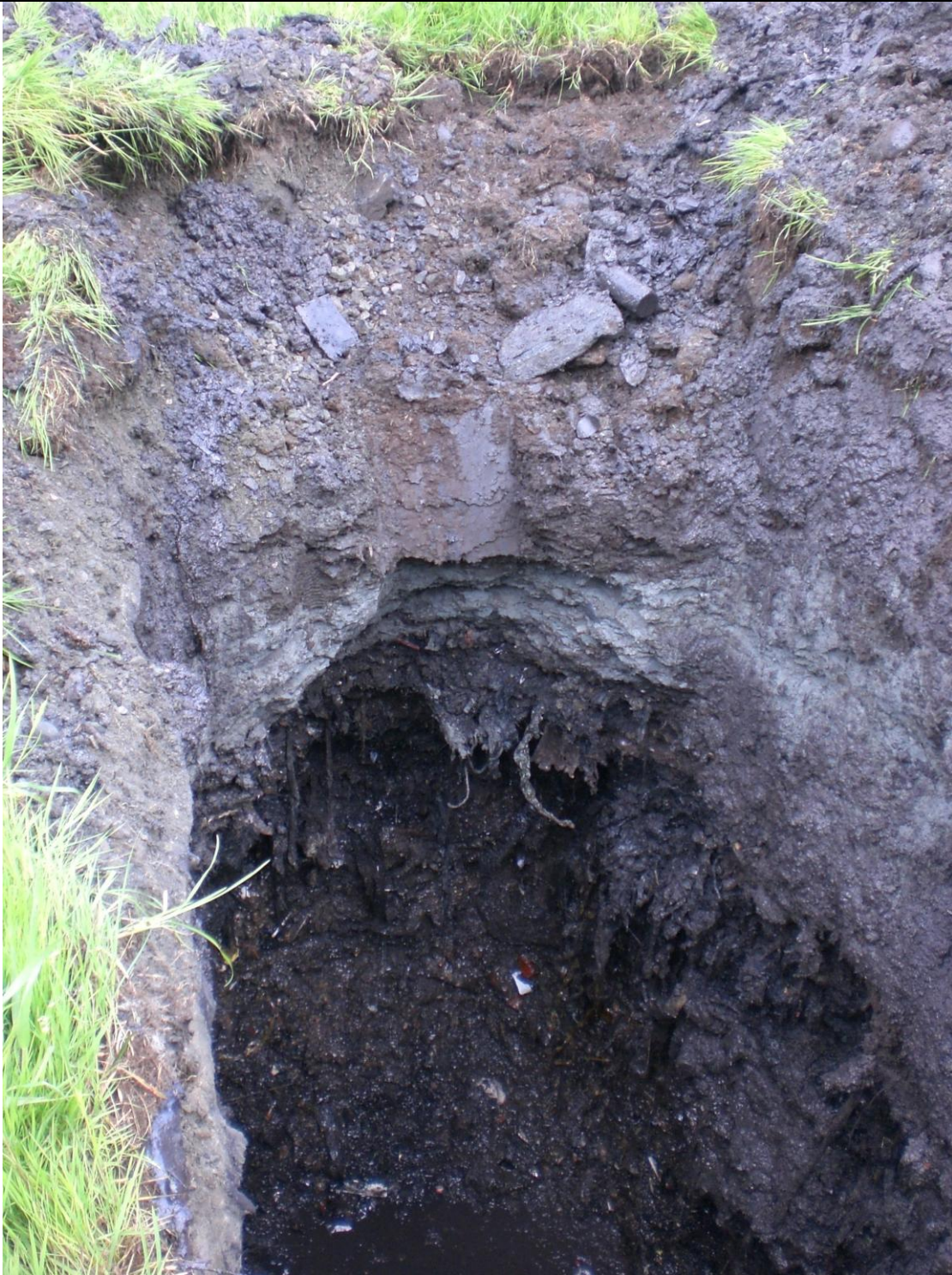
Foto 3-1. Sjakt 3. God overdekking. Underliggende avfall er vått. Sjaktveggene er nokså stabile, og massene er gravbare.
