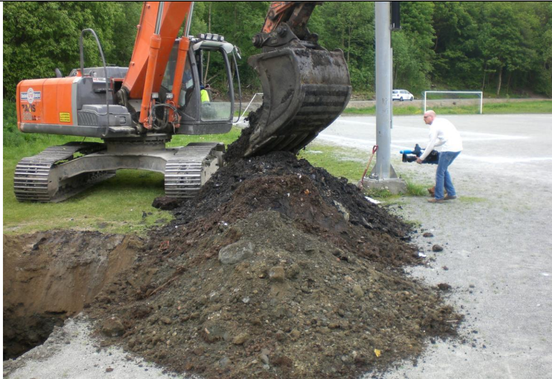
Foto 5-2. Sjakt 5. Oppgravde avfallsmasser har en viss struktur. Det meste av avfallet er en diffus "matrix", men det er innslag av noe plast og litt tre.. Svært lite stein.
