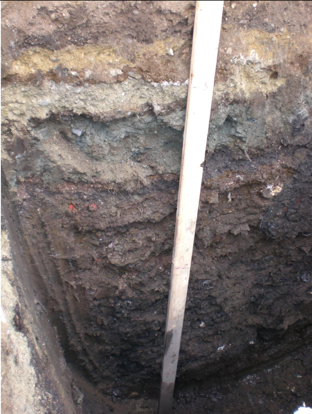
Foto 5-1. Sjakt 5. Relativt tørt avfall. Vann pipler inn fra ca 3meter under terreng. Sjaktveggene er stabile, og massene er gravbare.
