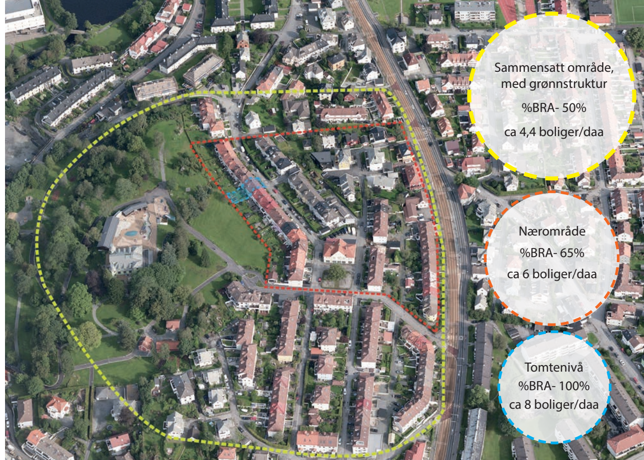
Figur: Tetthet på tomtenivå. Området som beregnes skal bare forsyne grunnareal til bygningsmassen og utendørs oppholdsareal og tilkomstareal.
