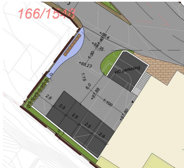
Figur 45 Oppstillingsplass for bosspann illustrert i blått felt, påtegnet tidl. utgave av illustrasjonsplan.
