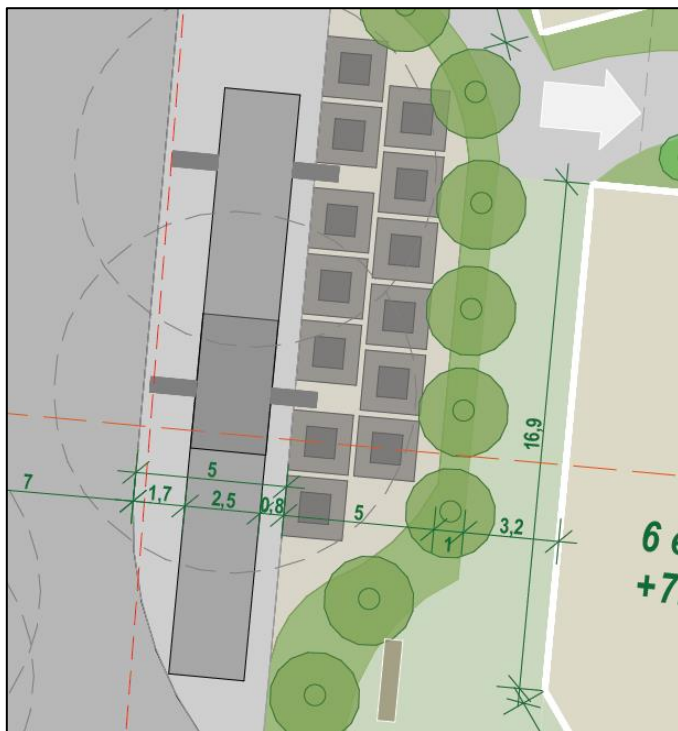
Figur 3-10 Målsettinger på kranbil / renovasjonslomme.
