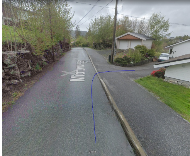
Figur 5: Nedsenket kantstein ved kritisk punkt sett mot sør.
