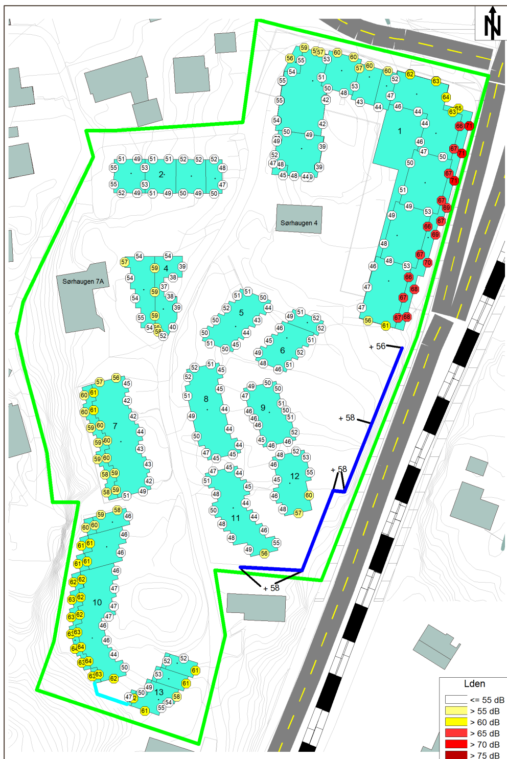
Figur 16: Høyeste støynivå L den ved fasade uavhengig av etasje med foreslått skjermingstiltak, eksisterende bygg «Sørhaugen 7A» og uten bygg 3.
