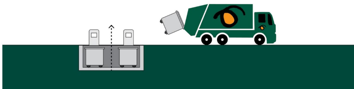
Figur 7 Nedgravd beholderløsning med hydraulisk lift (Lift-O-Mat eller tilsvarende). Illustrasjon fra BIRs RTV versjon 4.0.
