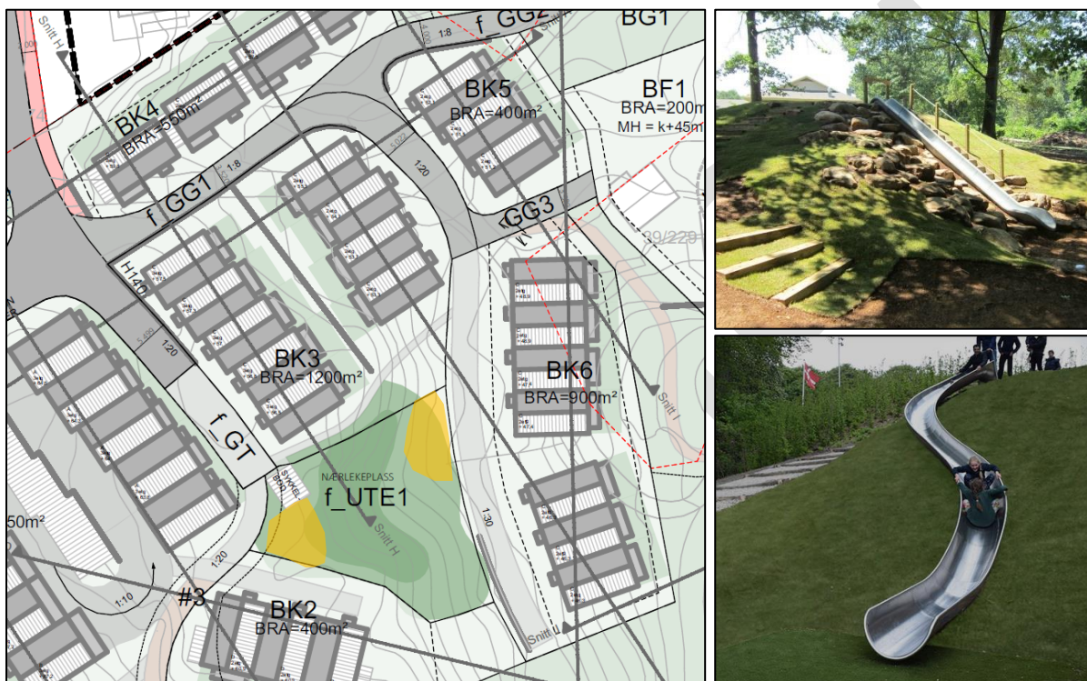
Figur 46: Utsnitt fra illustrasjonsplan t.v. viser to gule felt som illustrerer omtrent hvor terreng i f_UTE1 kan bearbejdes for å sikre universelt tilgjengelig tilkomst til lekeareal, også for boliger i østlige deler av planområdet. T.h.: Referansfoto over hvordan brattere deler av utearealet kan utnyttes, med for eksempel sklie, trapp og stein.
