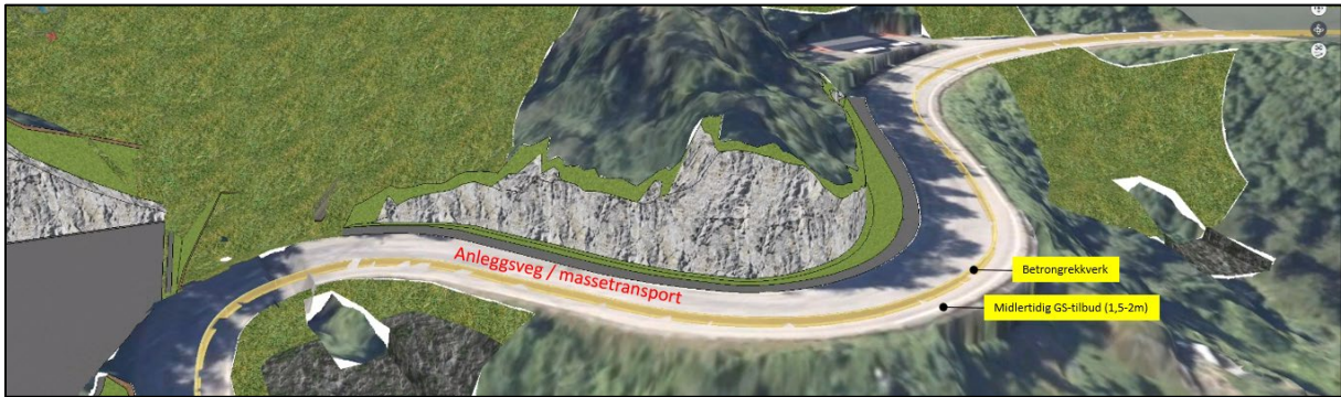
Figur 5-4 Midlertidig gang- og sykkeltilbud i Trengereidsvingane. GS-veg blir adskilt fra anleggsvegen med betongrekkverk.
