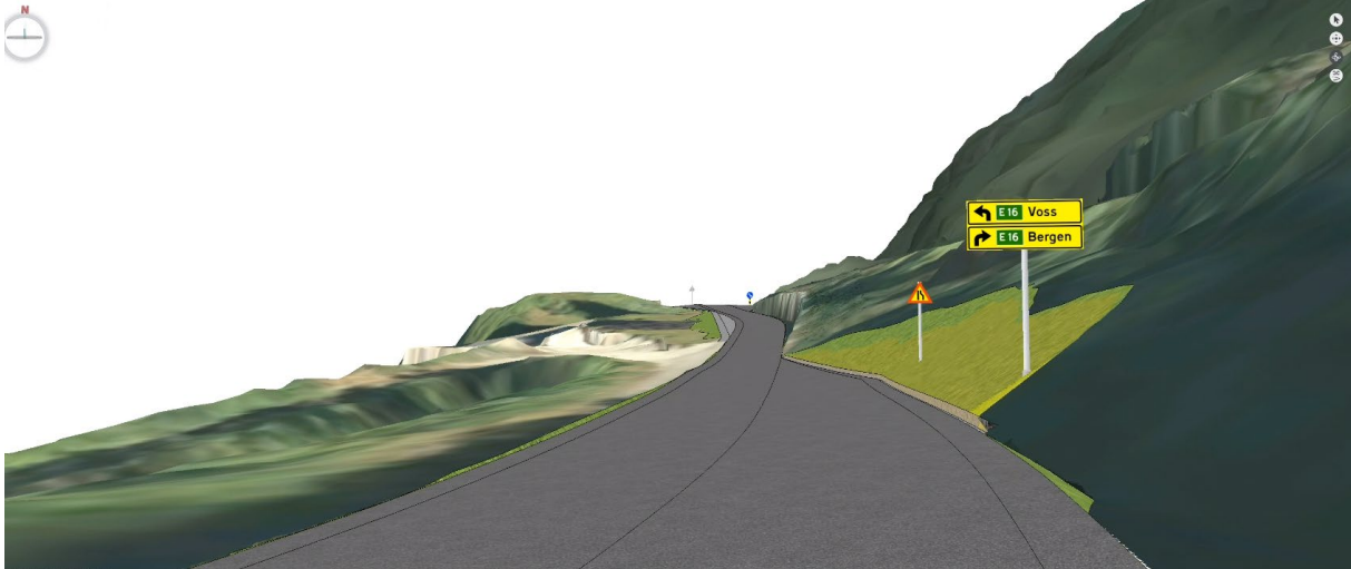
Figur 6-6 Lokalveg Rødberg, retning mot midlertidig kryss. Kjøretøy må her vente på motgående trafikk fra krysset. Enfeltsstrekning er ca 60 meter lang.
