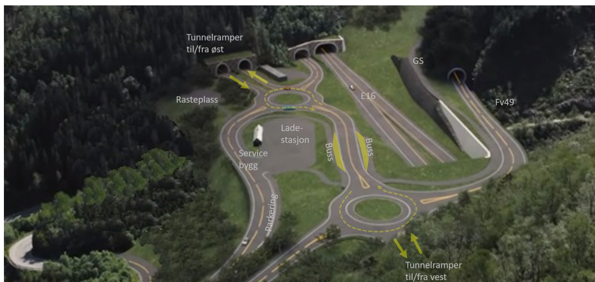
Figur 2-9 Trengereid. Illustrasjon av ferdig kryssområde
