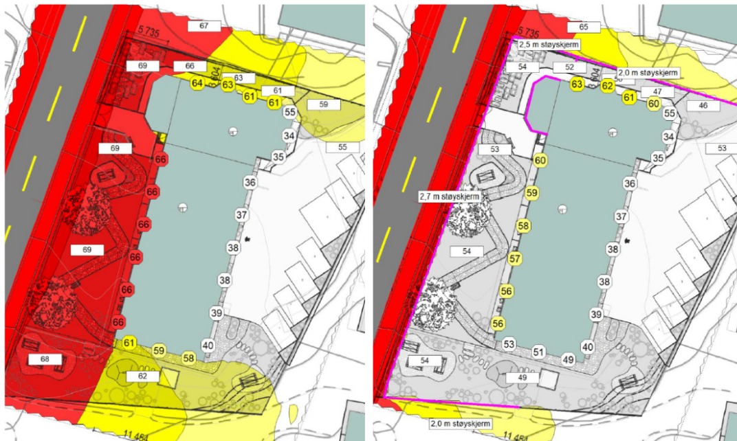
Figur 2 Støyutbredelse for uskjermet situasjon til venstre, og skjermet situasjon til høyre. Støyskjermen er vist med 2,7 meters høyde etter utvidelse av Øvre Fyllingsveien.
