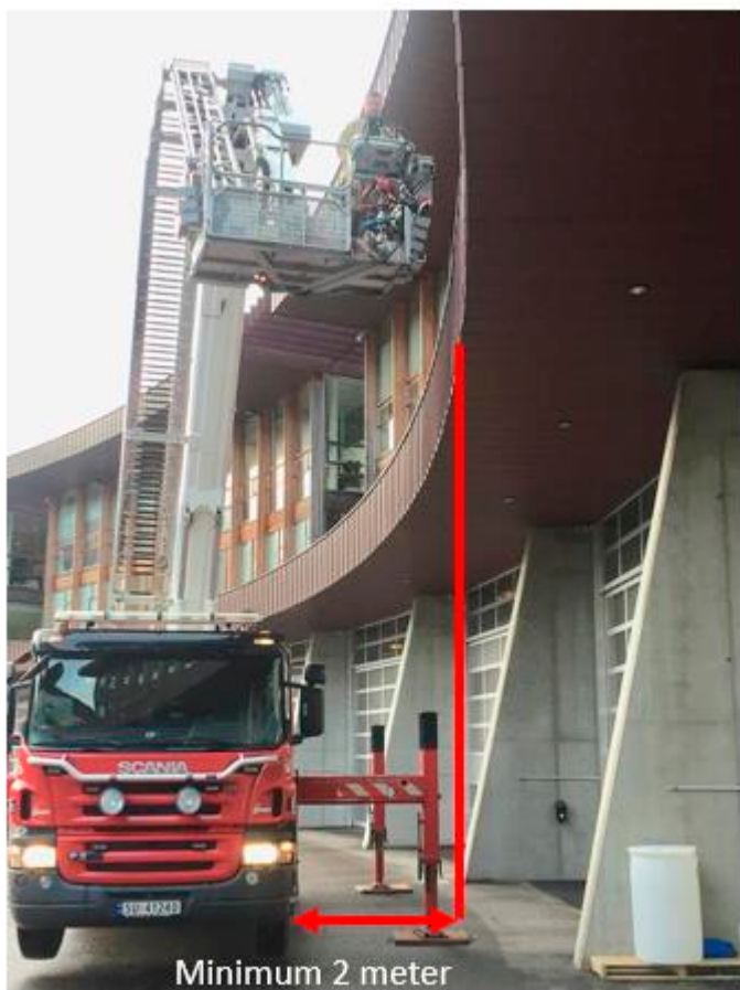
BILDE 3 MINIMUMS AVSTAND VED UTKRAGINGER O.L.
