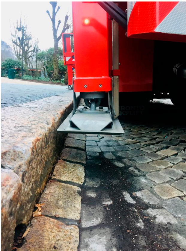
BILDE 5 VISER UTFORDRINGER MED FORTAUSKANTER OVER 15,0 CM.
