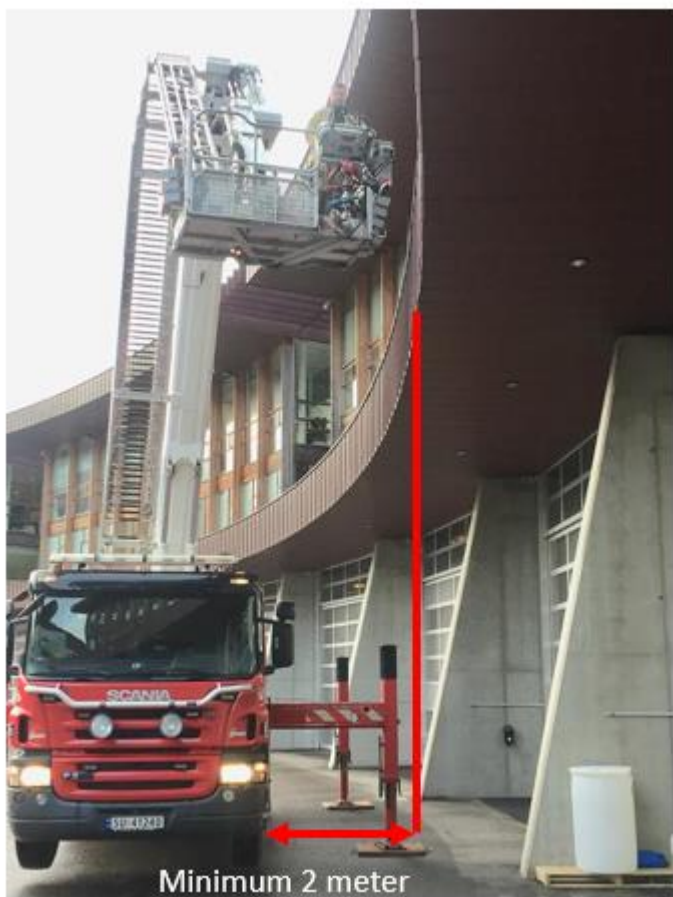
BILDE 3 MINIMUMS AVSTAND VED UTKRAGINGER O.L.
