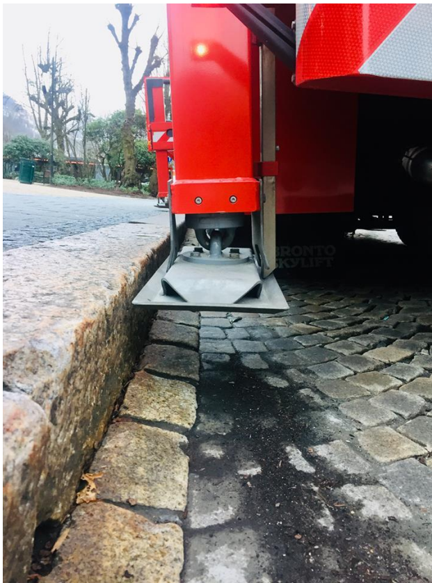
BILDE 5 VISER UTFORDRINGER MED FORTAUSKANTER OVER 15,0 CM.
