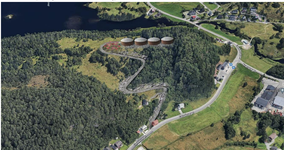
Visualisering sett i fugleperspektiv som viser store skjæringer langs vegen opp til høydebassengene.
